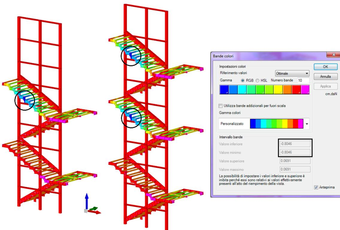
52 – Struttura in acciaio della scala: calcolo degli spostamenti massimi verticali della struttura in punti significativi
